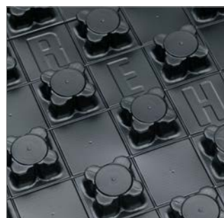
фиг. 3-12 Горна страна релефна плоча Varionova с изолация от ударен шум от долната страна 30-2 и топлоизолация от долната страна 11 mm
